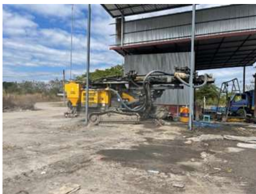
รูปที่ 2.2-3 เครื่องเจาะระเบิดแบบตีนตะขาบ
